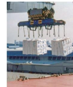
船上に設置した門型クレーンでつり上げる
